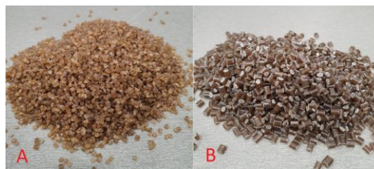
Obr. 1 Granulát: čistý PEEK (A), PEEK s prímесou keramiky (B)
