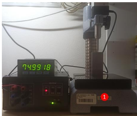
Obr. 2 Merací reťazec pre kalibráciu lineárneho dĺžkomera
