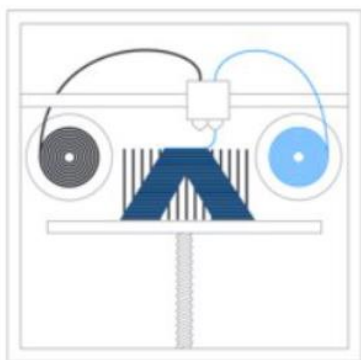
Figure 2. Schéma 3D tlače kompozitu [5]
