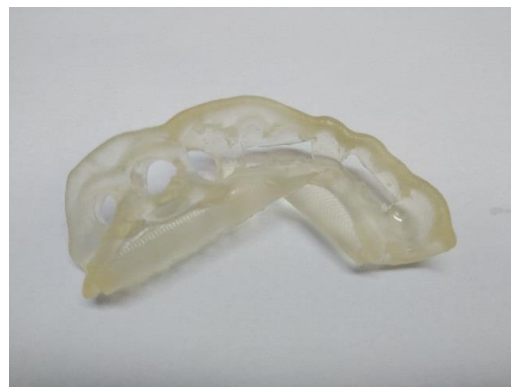
Obr. 6. Vytlačený navádzač na 3D tlačiarne Objet Eden 260
