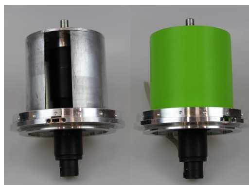
Figure 4. Porovnanie starého a nového jadra veľkého rotačného modulu
